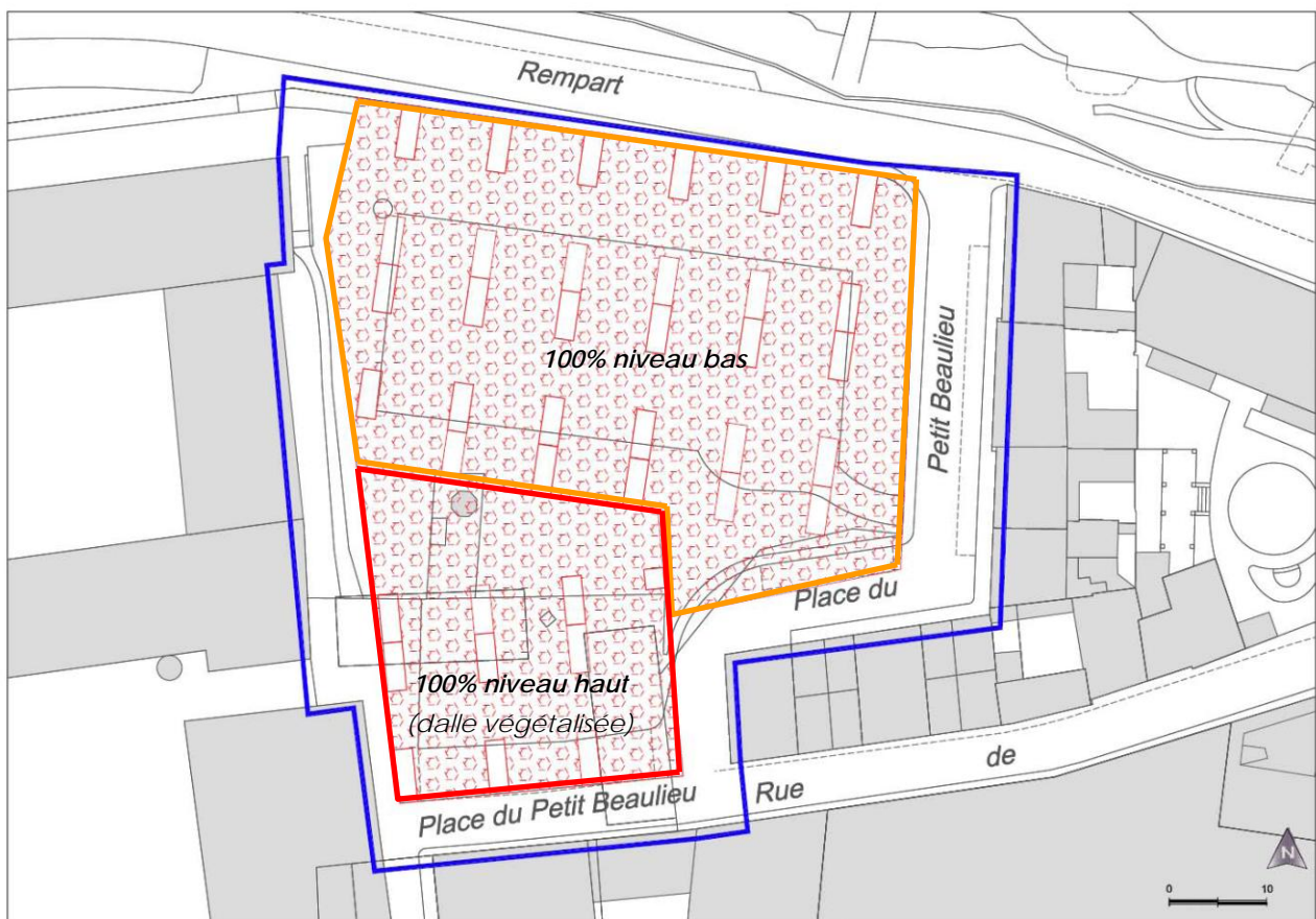
Emprise constructible maximale : R-1, et rez-de-chaussée
